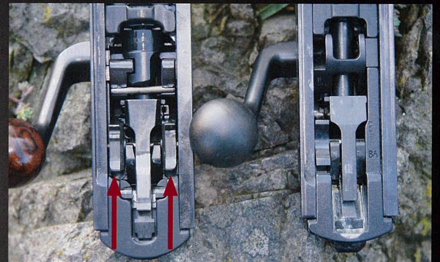
Neues Innenleben: In der R8 (links oben) finden sich zwei Kurvenscheiben (Pfeile) anstelle der einfachen bei der R93 (rechts oben). Zudem wurde die Geometrie der 14 Verriegelungselemente (Pfeile) samt korrespondierender Ringnut geändert, wie man im Vergleich zwischen R8 (links unten) und R93 (rechts unten) gut sehen kann.
