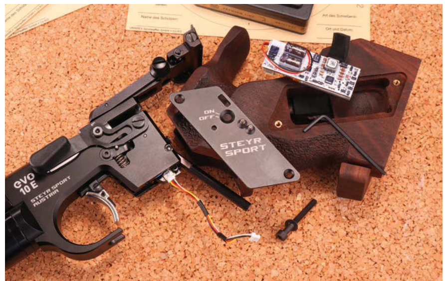
Die evo mit entferntem Griff: In einer Aussparung findet die Platine Platz und wird mit der Abdeckplatte fixiert. Ein Kabelbündel verbindet Elektronik und Waffe.
