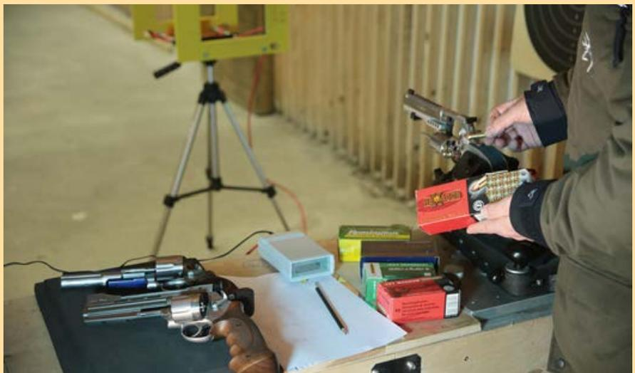
Versuchsanordnung: Beim Präzisions- und  $v_0$ -Test mussten sich die neuen Hexagon-Patronen mit gängigen Match-Patronen im Kaliber .357 Magnum messen. Und das aus insgesamt vier verschiedenen Match-Revolvern in der Ransom-Rest-Schießmaschine.
