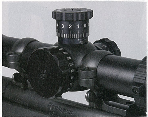
Griffgünstig. Die Parallaxeverstellung und Absehenverstellung liegen am Mittelrohr.
